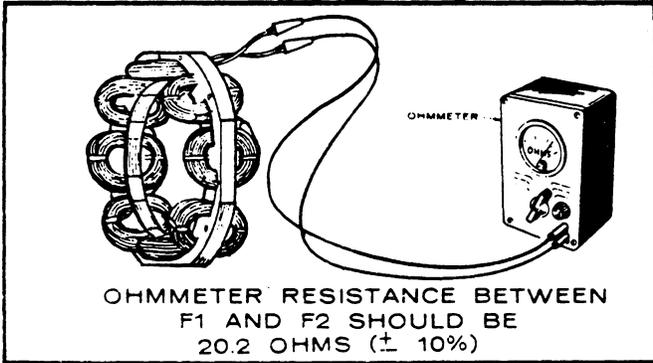
FIGURE 22. TESTING EXCITER FIELD
