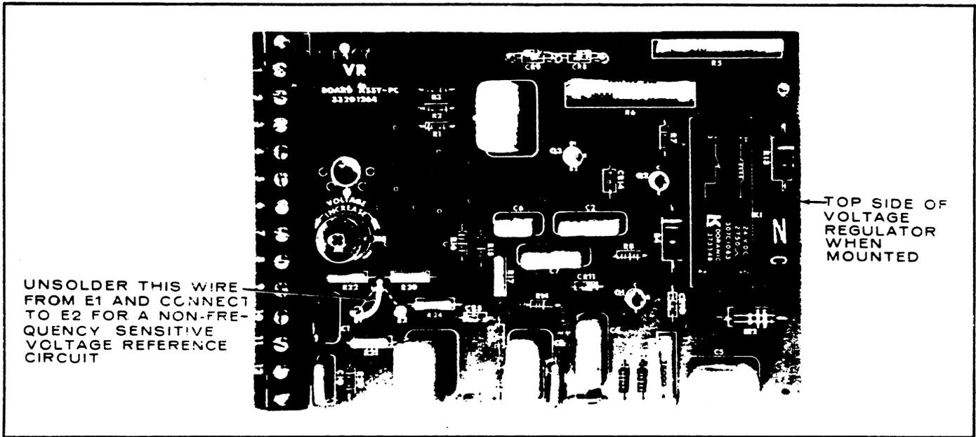
FIGURE 25. VR21 PRINTED CIRCUIT BOARD
