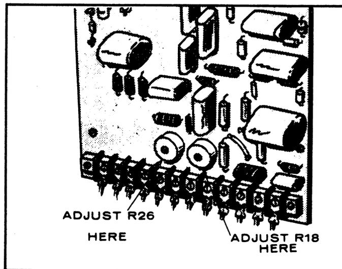
FIGURE 27. ADJUSTING VOLTAGE ON VR21
